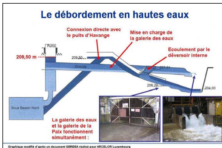
Illustration 20 : Schéma du dispositif de débordement du réservoir Nord
