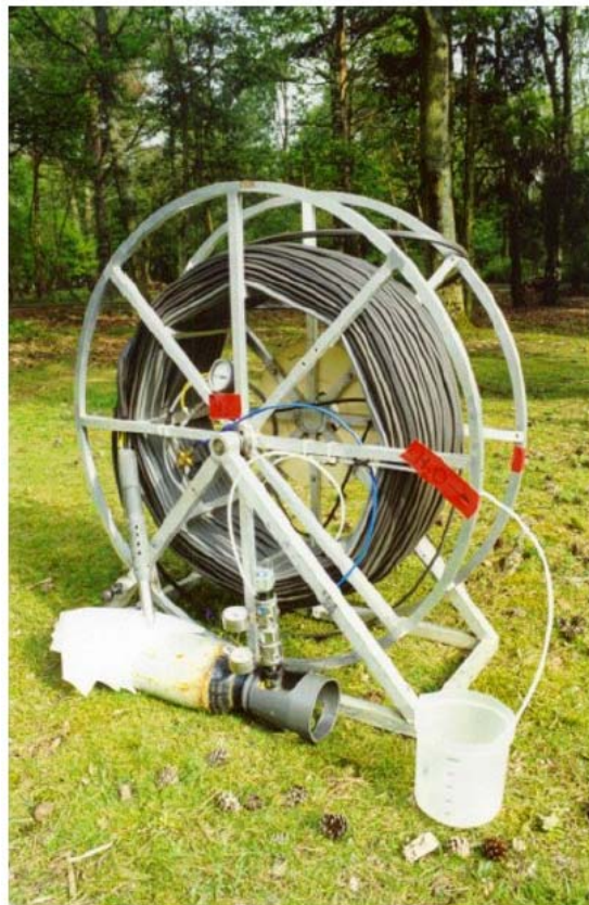
Illustration 18 : Exemple de préleveur mobile avec 300 m de bitube rilsant protégé par une membrane sur touret de capacité 600 m et bouteille portable d'azote sous pression
