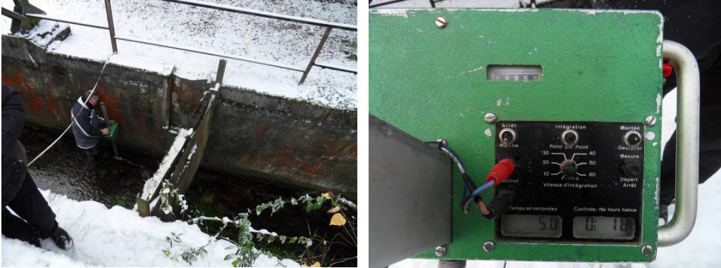
Illustration 10 : Jaugeage au micromoulinet à l'aide d'une perche de jaugeage à intégration à la station du Burbach
