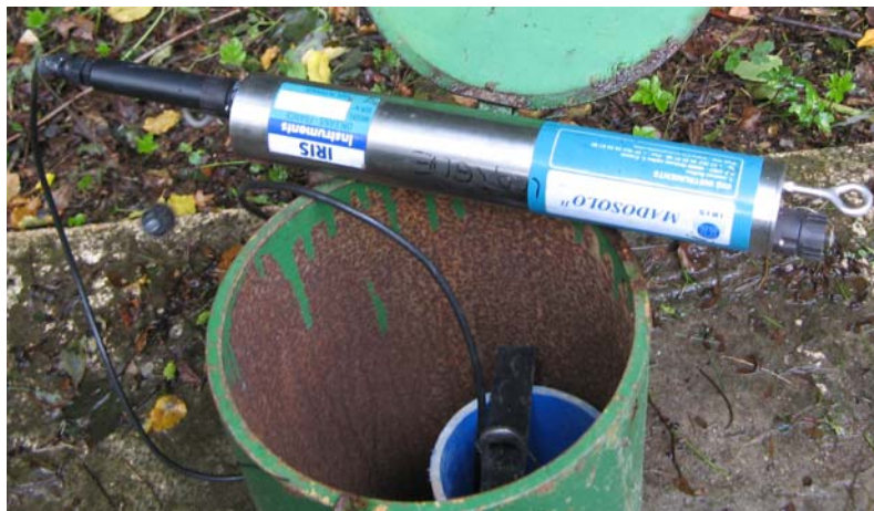
Illustration 9 : Appareil de mesure piézométrique et d'enregistrement Madosolo (IRIS ©)
